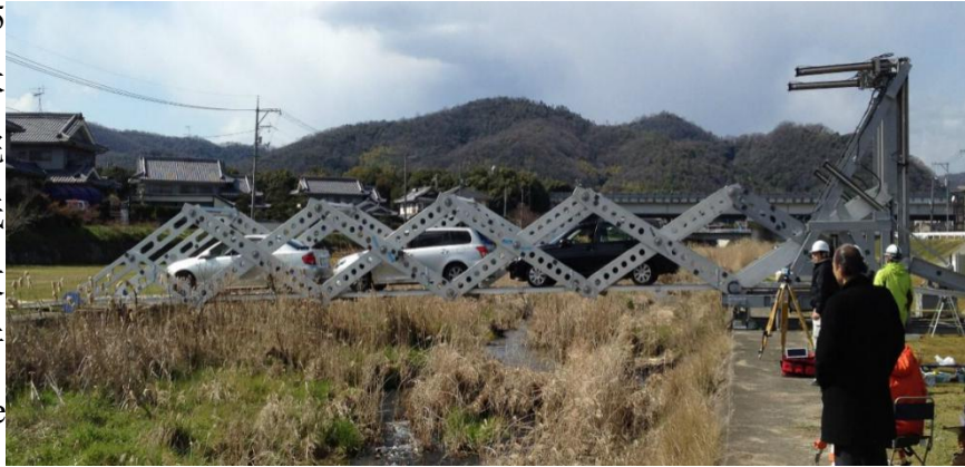
图1 日本 Mobile Bridge 安全装载测试（3辆车）
