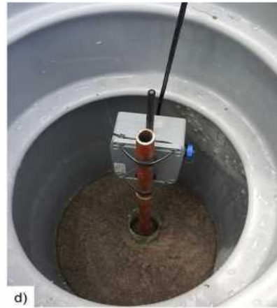
图 4 波导传感器连接的方法
