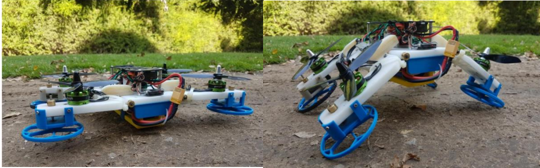
图 1 可自动变形的无人机机器人 FSTAR
